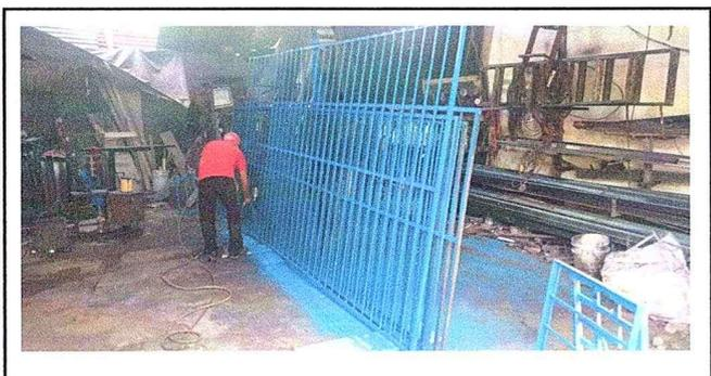
Foto 3: Se observa el avance de la fabricación de los balcones de metal.
