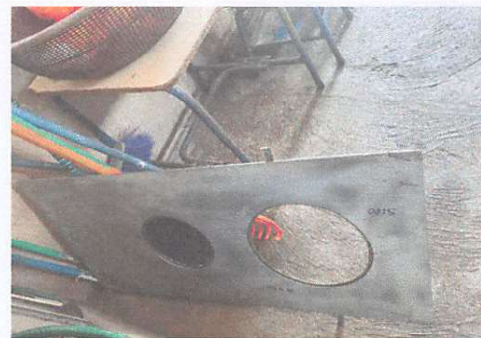
Foto 6: Sustrucción de plancha de metal de dos hornillas
