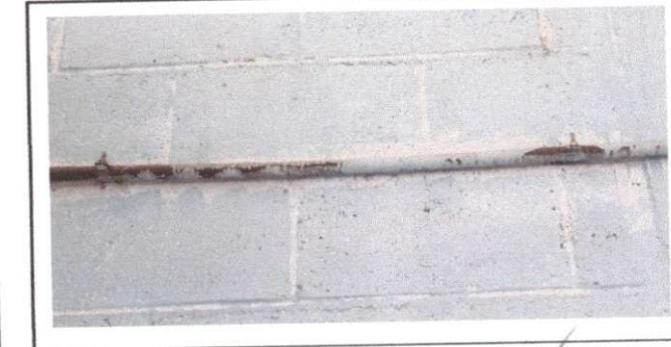
Foto 12: Sustrución de ducto eléctrico + accesorios ✓
