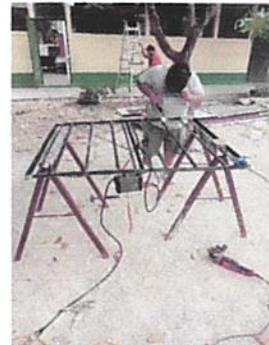
Foto 4: Sustrucción de estructura de metal de ventana
