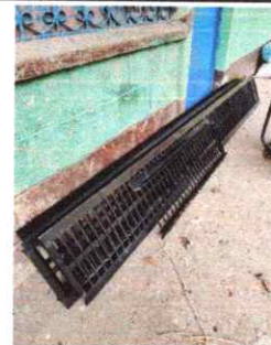
FOTO 6: ELABORACION DE PARRILLA PARA CUNETA
