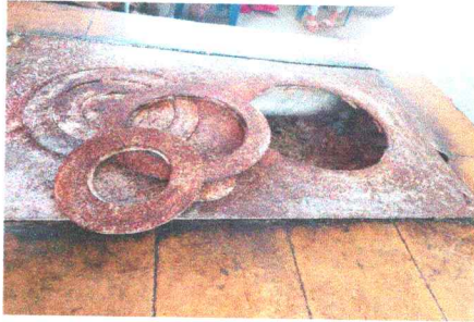
Foto 1: Sustitución de plancha de metal de 3 hornillas
