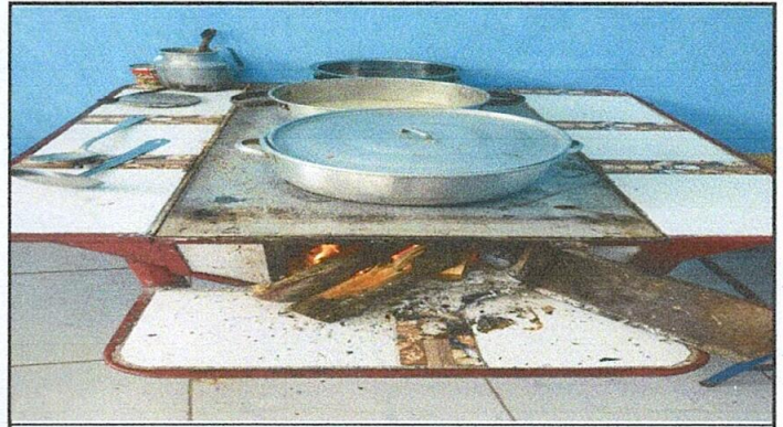
Foto 2: Sustitución de plancha de metal de 3 hornillas
