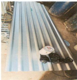
Foto 7: imagen que muestra la lamina troquelada aluzinc calibre 26 ms pintura y tornillos del modulo 1.
