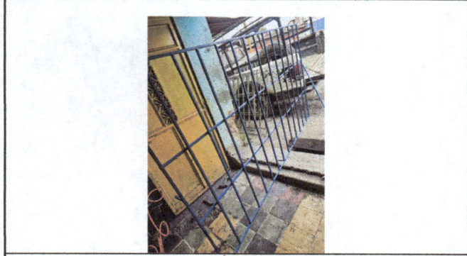
Foto 1: Elaboracion de balcón en el taller del proveedor
