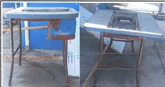
Foto 1: Fabricación de estufa o polletón de concreto ahorradora de leña con plancha y chimenea.
