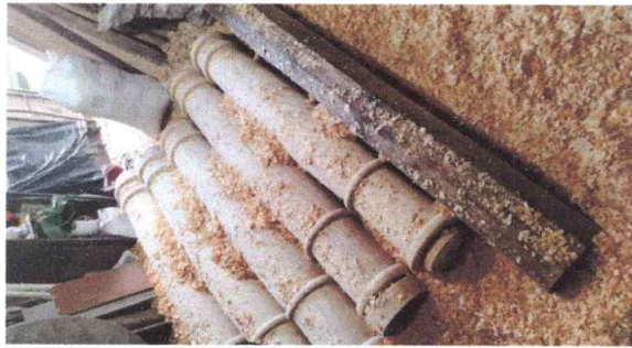
Foto 3: Columnas torneadas de madera nuevas.
