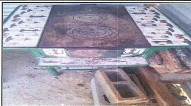
Foto 8: MODULO 2 Sustitución de estufa rural (completa) incluye chimenea y plancha de metal
