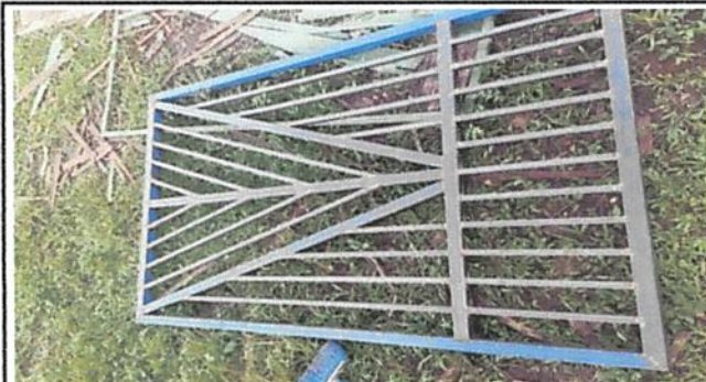
Foto 2: Fabricación eninstalación de portón de metal de ingreso.
