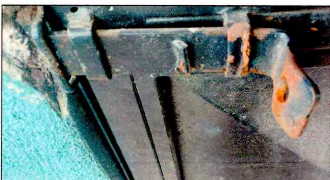
Foto 6: Puertas. Reparación y/o mantenimiento (desmontar, lijar o sustituir áreas oxidadas, limpiar, pintar y aplicar lubricante).
