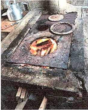
Foto 7: Sustrucción de plancha de metal de 3 hornillas.
