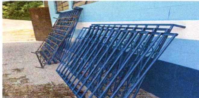
Foto 6: Fabricación e instalaciones de balcones de metal (1.85 mt x 1.95 mt)
