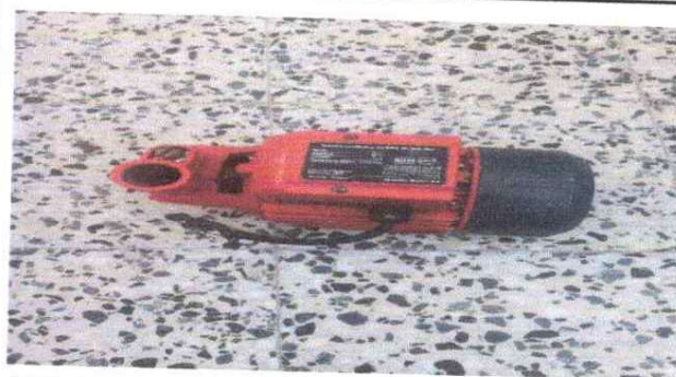
Foto 8: SUSTITUCIÓN DE BOMBA DE AGUA + ACCESORIOS
