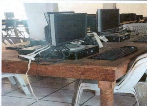
Foto 5: Instalación eléctrica inadecuada, en el laboratorio de computación; lo que provoca riesgos para los estudiantes.
