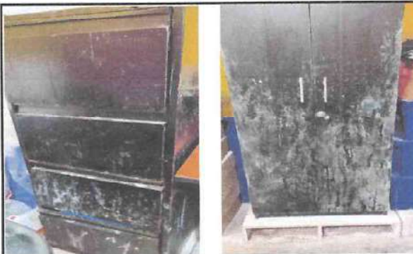
Foto No. 4 Muebles del aula No. 8 por humedad se aruinan los muebles.
