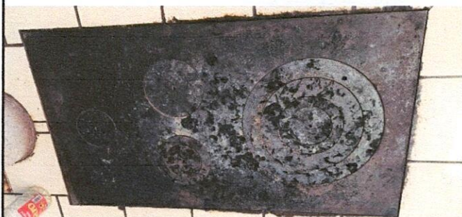
Foto 7: Sustitución de plancha para pollo de 3 ornillas.
