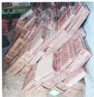
Foto1: Metros cuadrados de piso cerámico a utilizar en la sustitución de piso en aulas.
