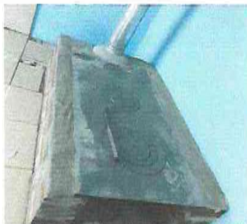
Foto 7: Sustrucción de estufa rural completa (incluye polletón, plancha y chimenea)
