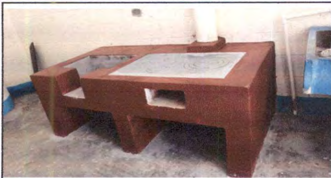
Foto 1: SUSTITUCIÓN DE POLLETÓN
