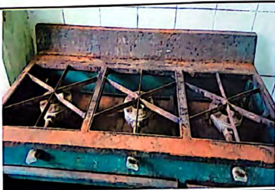
Foto 5: la estufa industrial está oxidada y picada. Necesita ser reemplazada.
