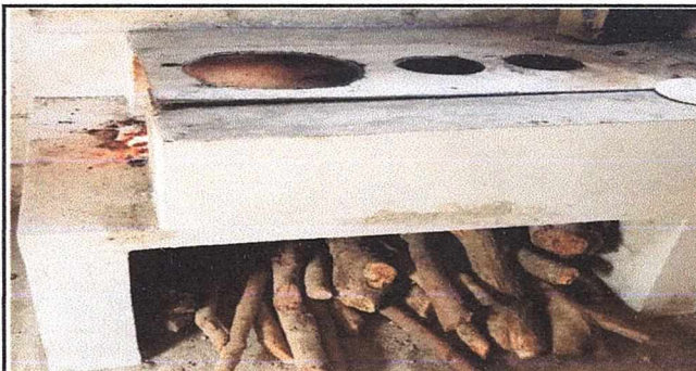
Foto 6: Hornilla para preparación de alimentos terminada.
