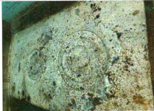
Foto 8: El estado de la plancha de metal no es el adecuado para cocinar los alimentos, por lo que se hace necesario cambiarla.
