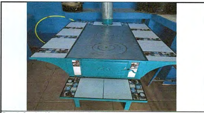
Foto 5: Sustitución de plancha de cocina.
