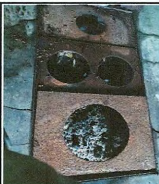
Foto 12: Sustitucion de plancha de metal de 3 hornillas y chimenea de metal.
