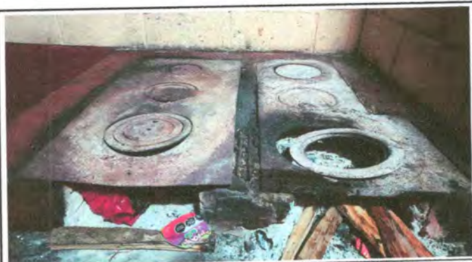
FOTO No. 9 Sustitución de planchas de 3 hornillas
