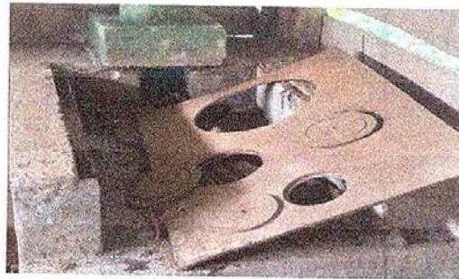
Foto 6: Sustitución de plancha de metal de 3 hornillas
