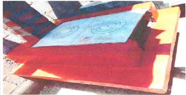
Foto 7: Sustitución de estufa rural (completa) incluye chimenea y plancha de metal, Ya esta terminado por el albañil.
