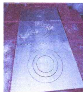
Foto 6: Sustitución de plancha de metal de tres hornillas.
