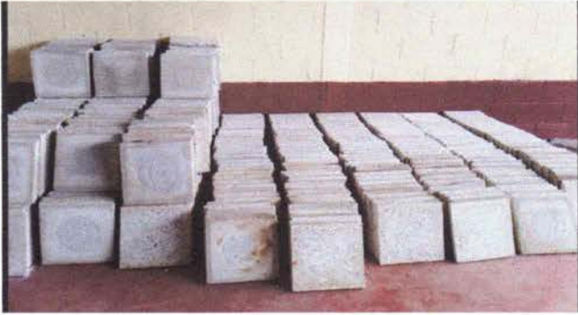
Foto1: Preparación del material para piso
