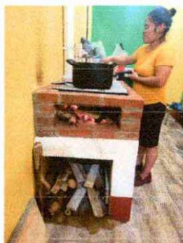
Foto1: La estufa artesanal ya terminada, elaborada con ladrillo en el area de cocina.
