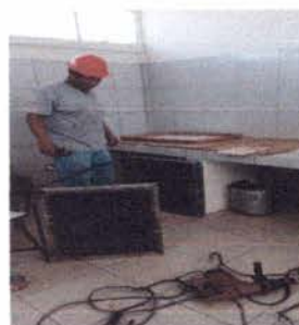
Foto 14: 19. MANO DE OBRA ESPECIALIZADA EN ( ALBAÑILERIA, ELECTRICIDAD HERRERIA Y PLOMERIA)/ 19.3 Fabricacion de puertas de metal en modulos.
