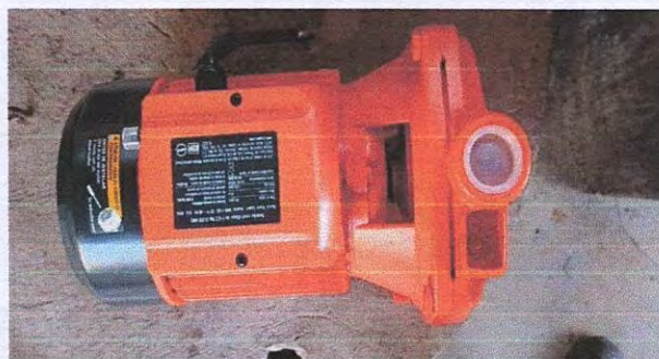
Foto 10: 18.7 Sustitución de bomba de agua.
