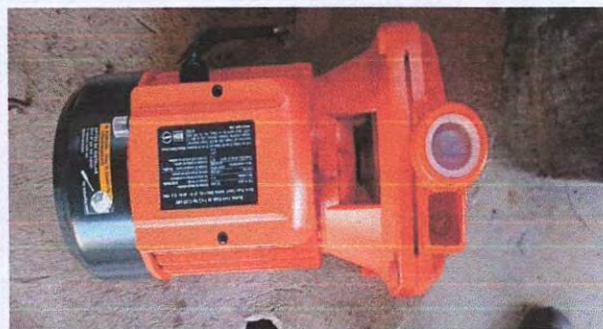
Foto 10: 18.7 Sustitución de bomba de agua.
